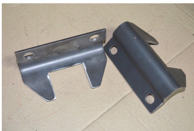
ZABEZPIECZENIE KURKA KOŃCOWEGO
